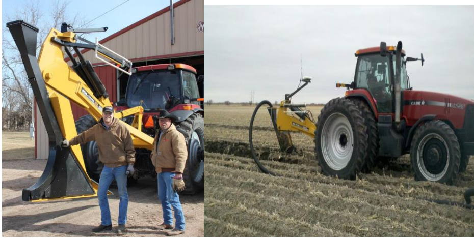
Şekil 8. Tekerlekli trenchles (a) ve trenchles ekipmanı (b)
