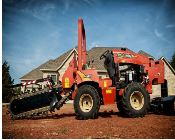
Şekil 6. Traktöre monteli trencher ekipmanı (Anonim 2021d)
