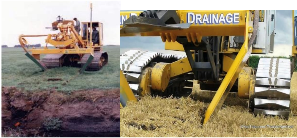
Şekil 9. V type trenchles bıçağı (Anonim 2021f)
