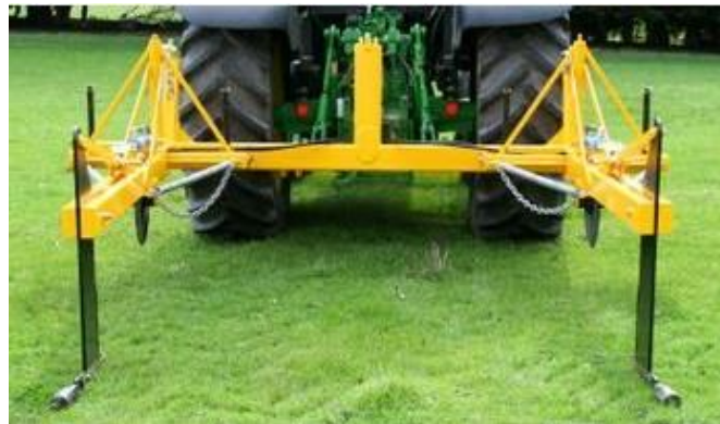
Şekil 10. Mol Pulluğu a, b, c (Anonim 2021g, h, ı)
