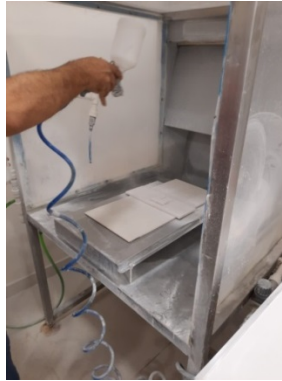
Şekil 1. Spreyleme tekniği ile sır uygulama işleminin gösterimi
