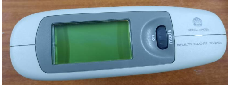
Şekil 4. Konica-Minolta marka Multi Gloss 268 plus model parlaklık ölçüm cihazı
