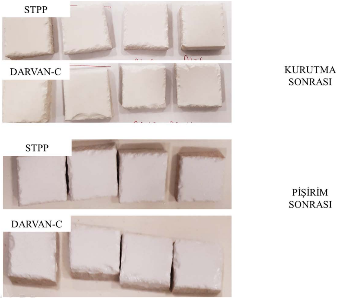
Şekil 3. Sır kompozisyonlarının yüzeye uygulanıp kurutma işleminden ve pişirme işlemlerinden sonra yüzey özellikleri (çatlama gözlenmemiştir)
